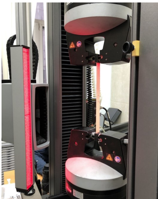
Рисунок 2.5. Образец перед испытанием на растяжение
