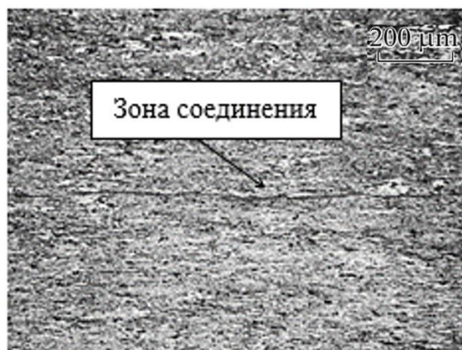
Рисунок 5 - Микроструктура в зоне соединения двух заготовок из сплава АМг2
