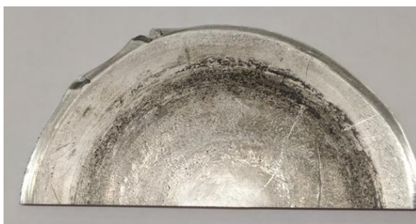
Рисунок 3 - Гибридная заготовка из сплава АМг2 после холодной осадки с кручением
