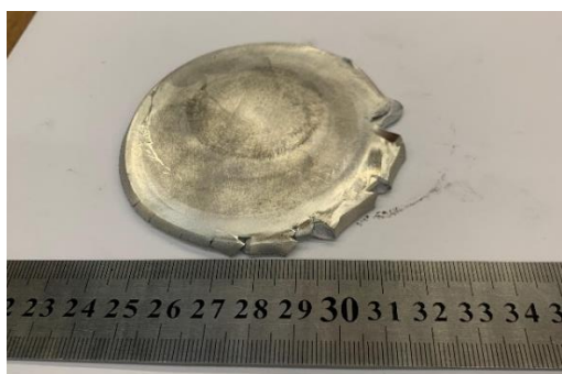
Рисунок 4 - Гибридная заготовка из сплава АМг6 после холодной осадки с кручением
