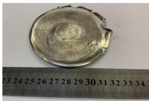
Рисунок 4 - Гибридная заготовка из сплава АМг6 после холодной осадки с кручением
