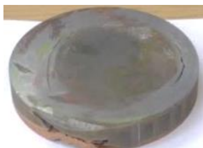
Рисунок 9 - Гибридная заготовка из 2 разных сплавов: OT4-1 и БрX0,8 после горячей осадки с кручением
