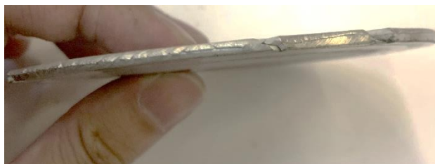
Рисунок 3 - Гибридная заготовка из сплава АМг2 после холодной осадки с кручением
