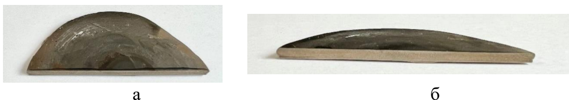
Рисунок 1 - Гибридная заготовка из сплава ОТ4-1, полученная горячей осадкой с кручением (а) и ее сечение (б)
