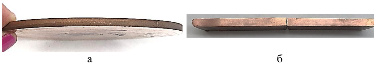
Рисунок 7 - Гибридная заготовка из сплава БрX0,8-Ш после холодной осадки с кручением:
