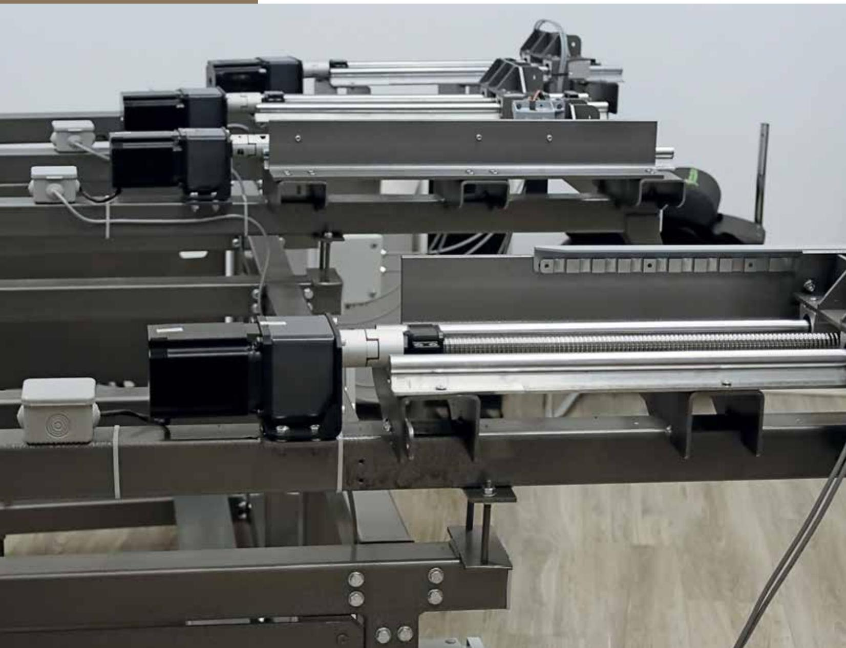
◀ Стенд контроля перекоса крыла для SSJ New
