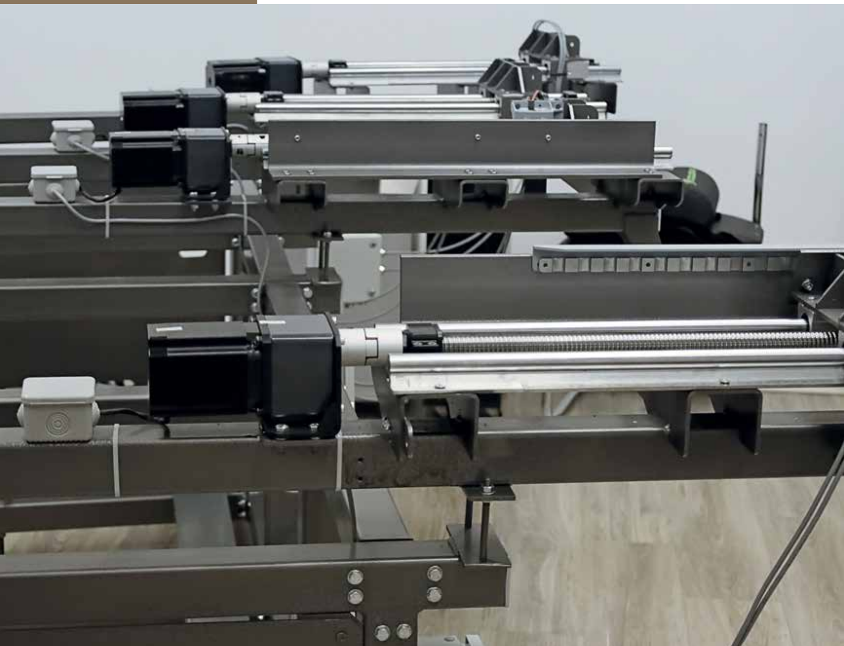
◀ Стенд контроля перекося крыла для SSJ New
