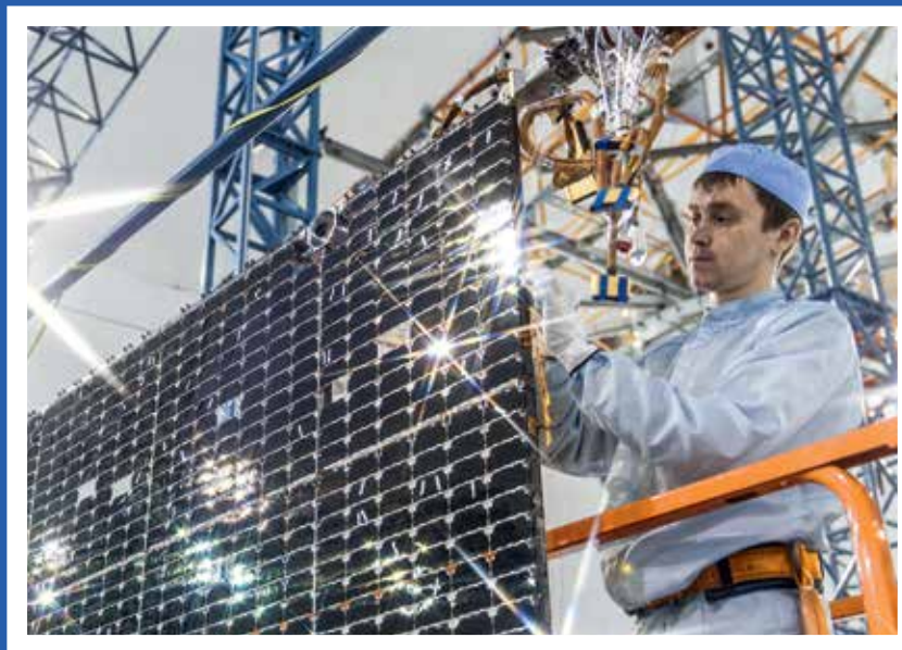
Монтаж кабельной сети солнечных батарей в цехе изготовления крупногабаритных трансформируемых конструкций и антенно-фидерных устройств
