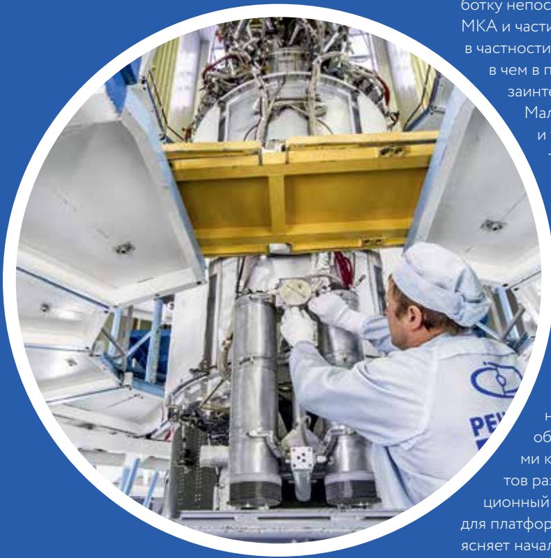
Сборка космического аппарата «Гло-насс-М» в цехе окончательной сборки
