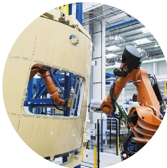
● Сверление отверстий и установка крепежа в часть фюзеляжа Airbus A350 при помощи промышленных роботов на производстве в Stelia Aerospace (Méalte, France)
