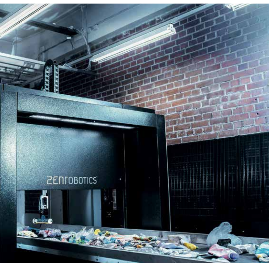
Системы сортировки мусора ZenRobotics оснащены модулями компьютерного зрения и машинного обучения
