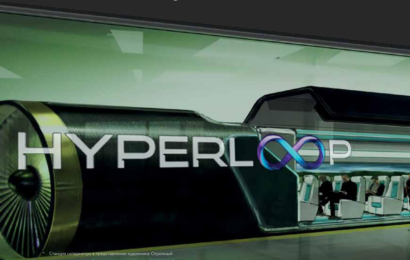
^ Станция гиперметро в представлении художника. Огромный вентилятор в носовой части нагнетает воздух для воздушной подушки. Фото: Virgin Hyperloop One
