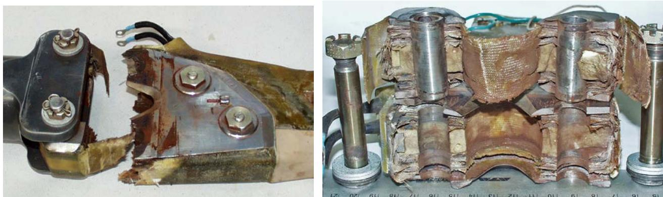
Рис. 8 Усталостное разрушение рулевого винта по перемычкам отверстий комлевого стыка
