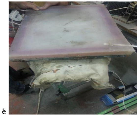
Рисунок 20. Ламинат в вакуумном мешке, подготовленный для отверждения и процесс вакуумной упаковки.
