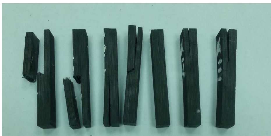
Рисунок 1.34. Фото образцов после испытаний на изгиб наномодифицированного углепластика с укладкой 90 4 .
