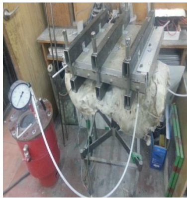
Рисунок 21. а) Вакуумный мешок с манометром, б) Прибор для измерения давления, в) Термометр.
