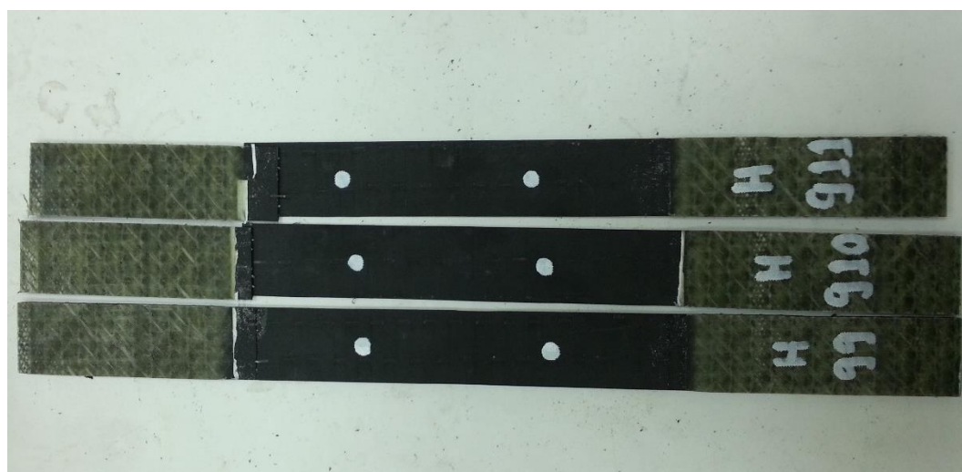
Рисунок 1.25. Фото характерных образцов наномодифицированного углепластика для партии с укладкой 90 4 .
