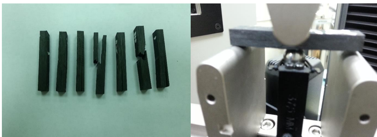
Рисунок 1.31 Фото образцов после испытаний на изгиб углепластика с укладкой 90 4 .
