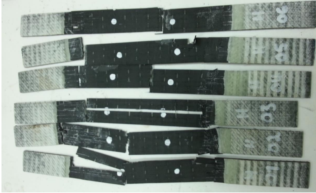
Рисунок 1.19. Фото образцов наномодифицированного углепластика после испытаний на растяжение с укладкой 0_4 .
