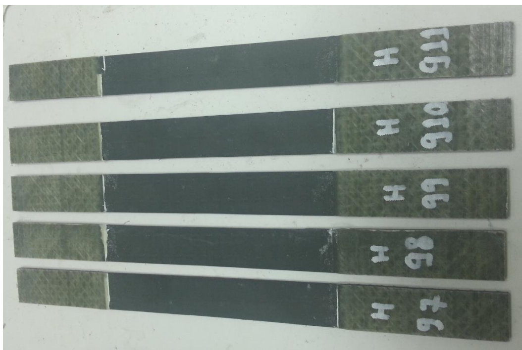
Рисунок 1.23. Фото образцов наномодифицированного углепластика до испытаний на растяжение наномодифицированного углепластика для партии с укладкой 90 4 .
