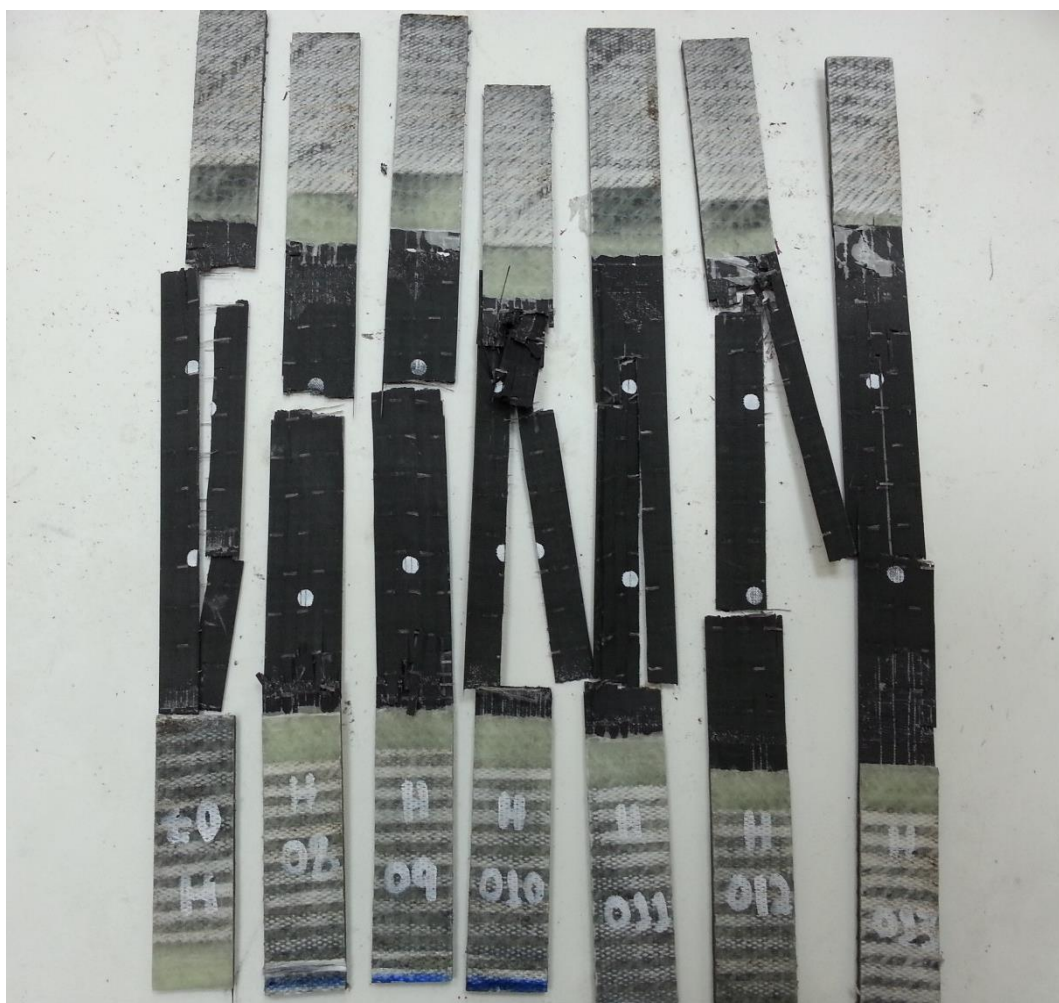
Рисунок 1.22. Фото образцов наномодифицированного углепластика после испытаний на растяжение с укладкой 0_2/90_4/0_2 .
