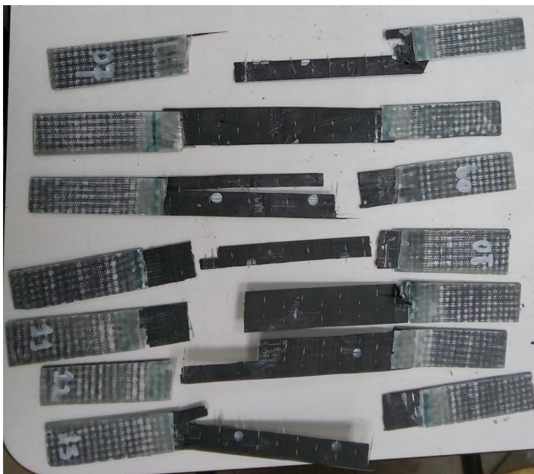
Рисунок 1.10. Фото образцов после испытаний на растяжение с укладкой O_2/90_4/O_2 .
