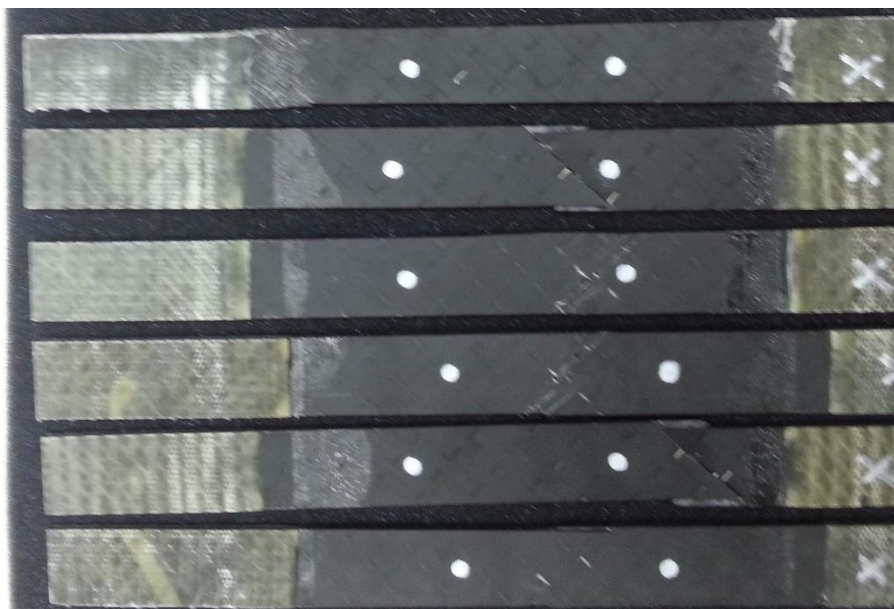
Рисунок 1.16. Фото образцов после испытаний на растяжение с укладкой +45 2 /-45 4 /+45 2 .
