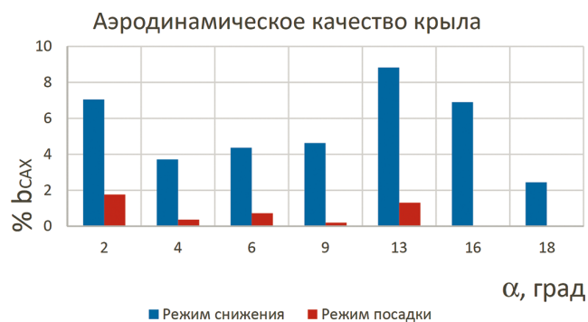
Рис. 7. Графики влияния ремонтной наклейки на аэродинамическое качество крыла
