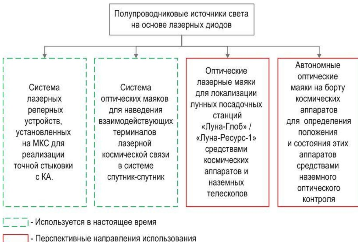
Рисунок. 1 Области применения полупроводниковых источников света для КА
