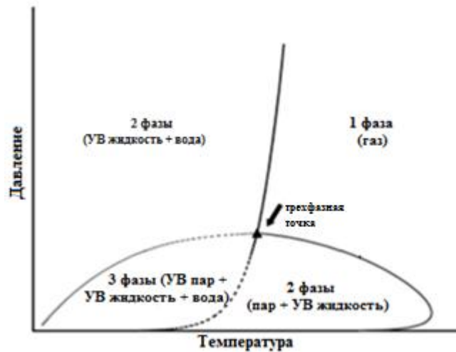
Рисунок 3.1. Фазовая диаграмма системы «пластовая углеводородная газоконденсатная смесь – вода»[111]
