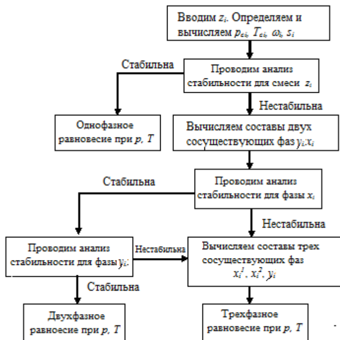
Рисунок 3.2. Общая схема расчета трехфазного равновесия в многокомпонентной системе
