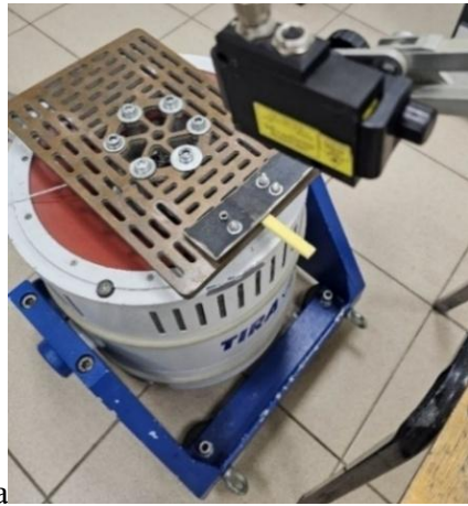
Рисунок 6. Снимок динамического испытания с образцом из материала с плотностью: а) 80 кг/м 3 ; б) 100 кг/м 3 .
