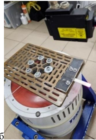
Рисунок 6. Снимок динамического испытания с образцом из материала с плотностью: а) 80 кг/м 3 ; б) 100 кг/м 3 .
