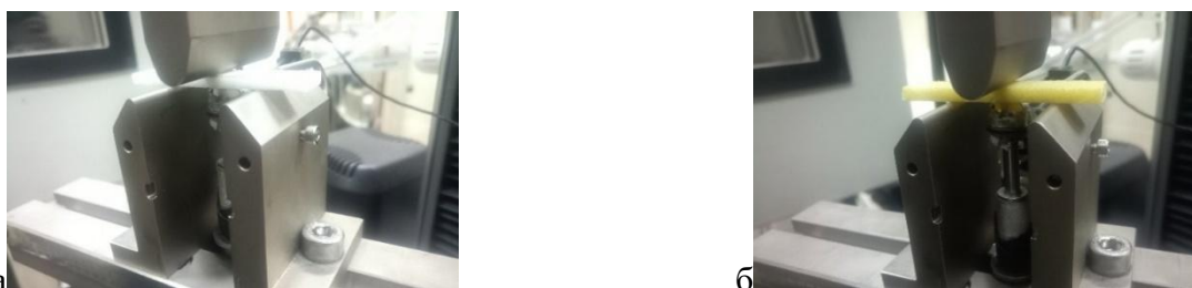
Рисунок 2. Образец во время проведения испытаний (а - для материалов с плотностью 80 кг/м 3 , б - для материалов с плотностью 100 кг/м 3 ).
