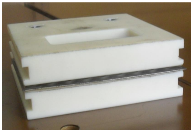
Рисунок 4 – Приспособление формы для сварки пластин (ложемент)
