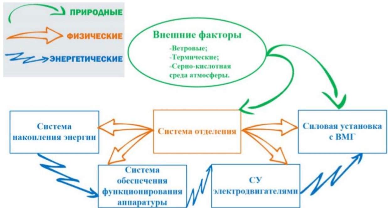
Рисунок 23 – Функциональная схема МРЛА.
