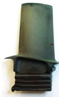
Рис. 14. Повреждения (трещины), зарегистрированные методом ЛЮМ [16]
