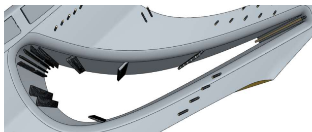
Рис. 2. Система охлаждения сопловой лопатки
