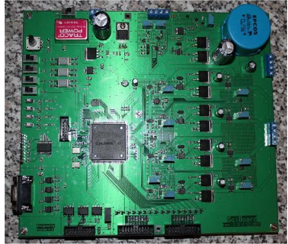
Рис.9. Плата управления вентильным двигателем
