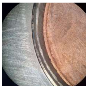
Рис. 6. Результат электронно-лучевой сварки мишени с фланцем. Вид со стороны охлаждения
