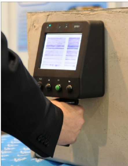
Рисунок 12 – Внешний вид макета радиолокатора для обнаружения людей за стенами
