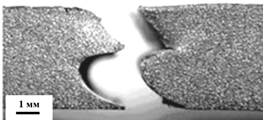
Рисунок 4.9 – Разрушение сварного соединения листов сплава 1565чН116 по зоне термомеханического воздействия
