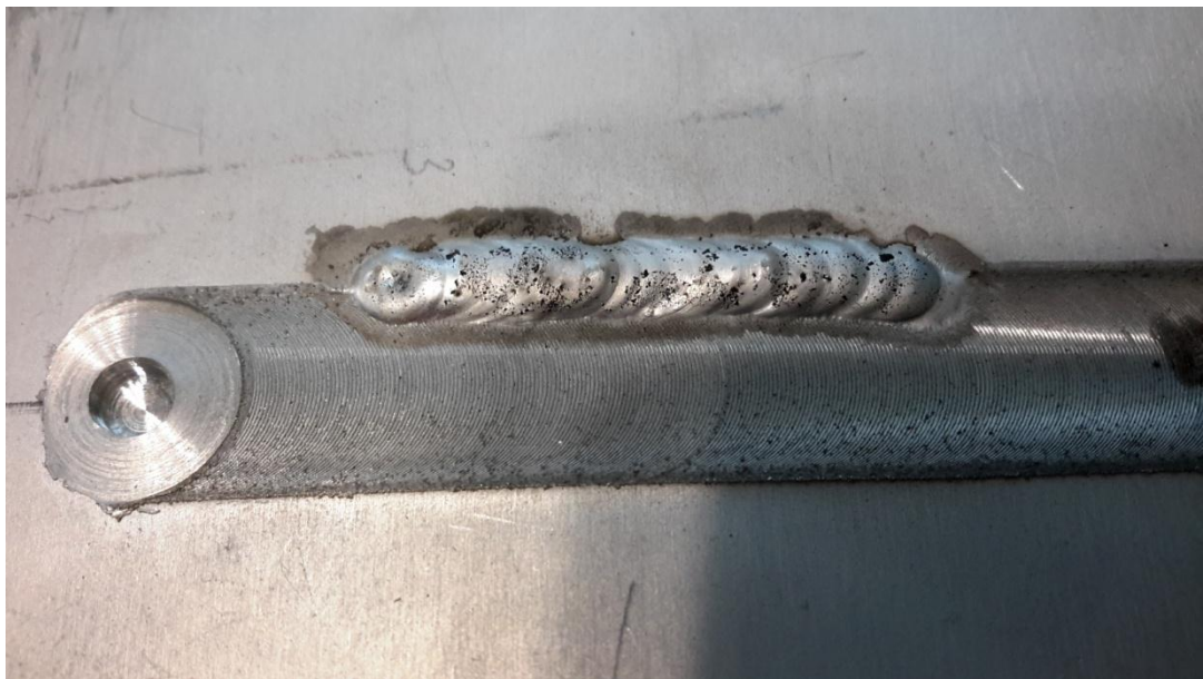
Рисунок 5.10 – Аргонодуговая подварка непротяженного несплавления в шве сплава 1565чМ, полученного сваркой трением с перемешиванием
