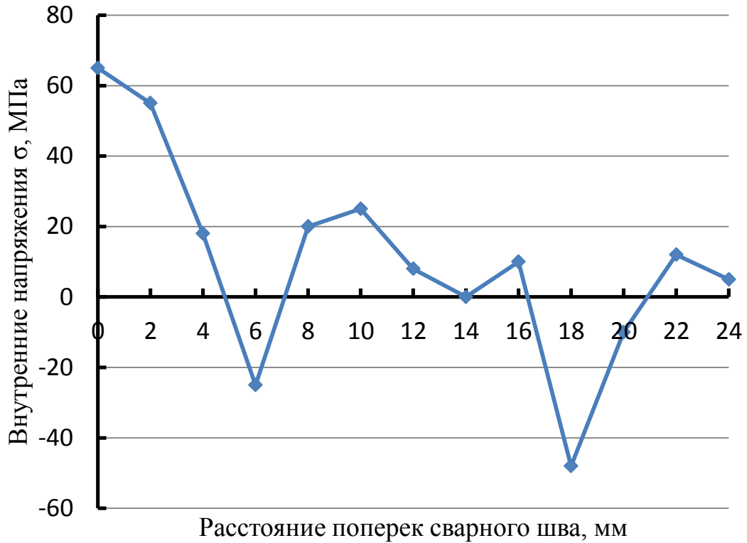
Рисунок 3.26 – Профиль внутренних напряжений в сварном соединении сплава системы легирования Al–Cu–Mg, выполненном СТП, на уровне середины толщины
