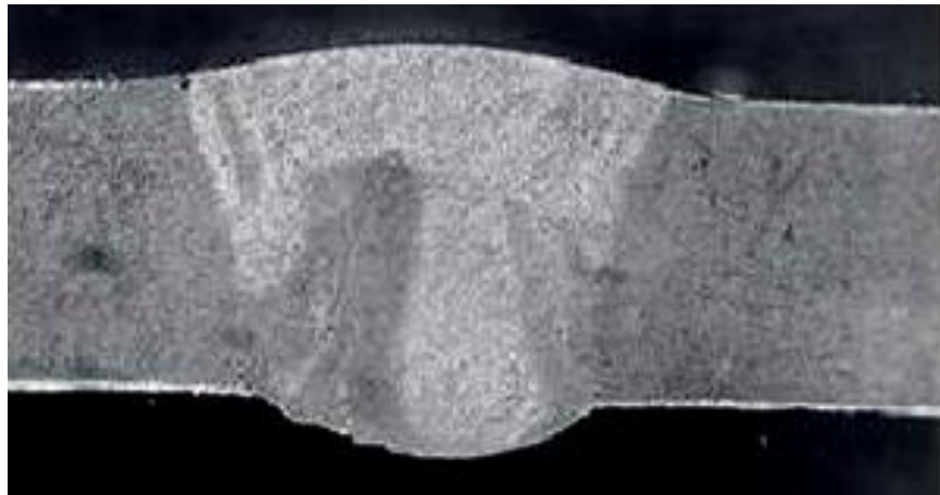
Рисунок 3.7 – Макроструктура сварного соединения сплава 1565ч (x6), выполненного автоматической аргонодуговой сваркой с присадочной проволокой СвАМг63
