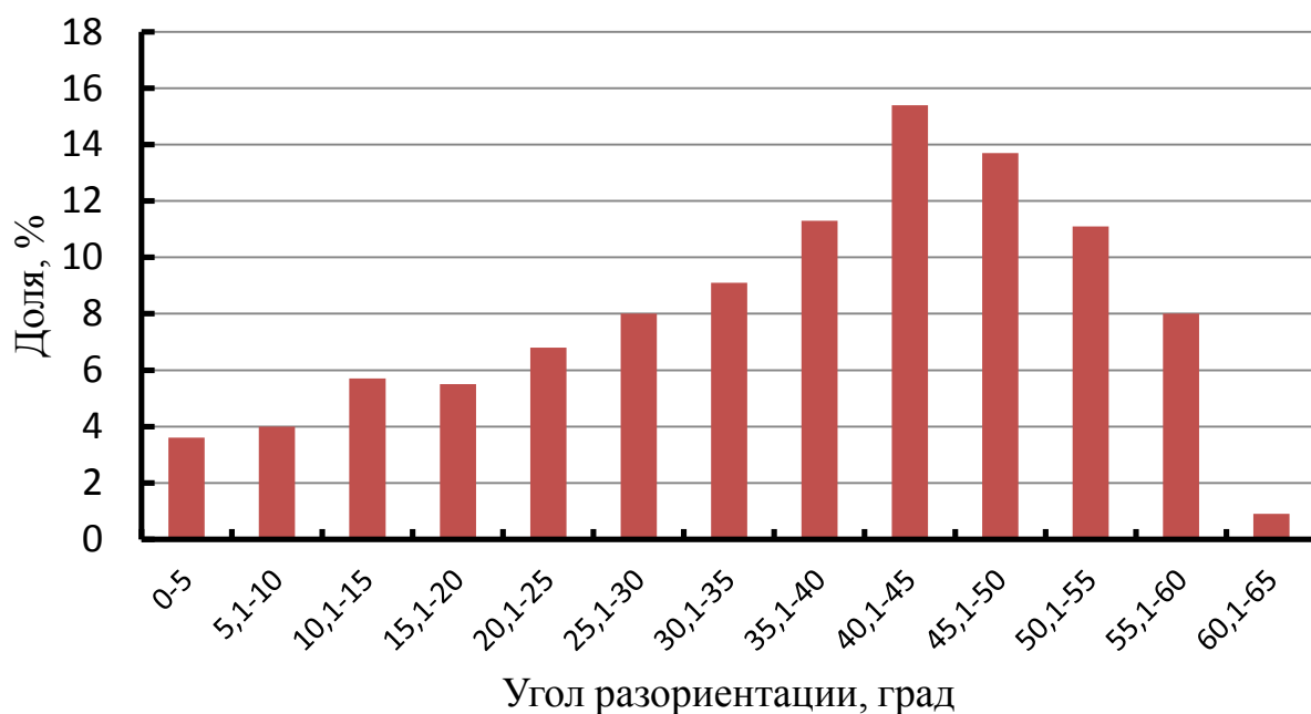
Рисунок 3.18 – Обратная полюсная фигура с нанесенными большеугловыми и малоугловыми границами (а), распределение по углам разориентировки (б) металла шва сплава 1565ч
