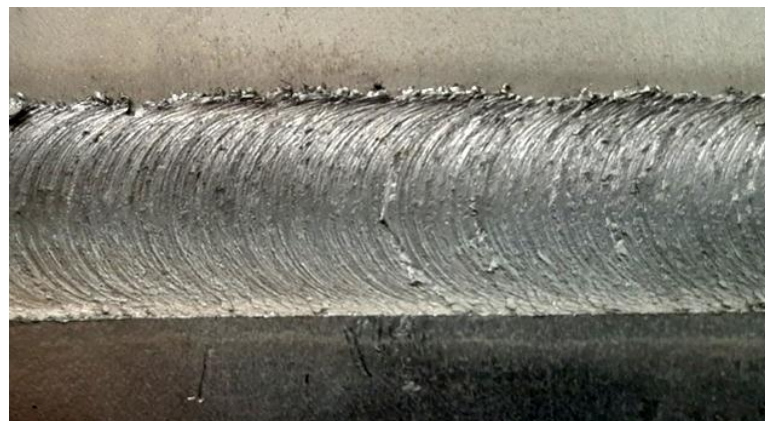
Рисунок 4.3 – Внешний вид швов сплава системы Al–Cu–Mg, выполненных СТП на воздухе (а) и в ванне с проточной водой (б)
