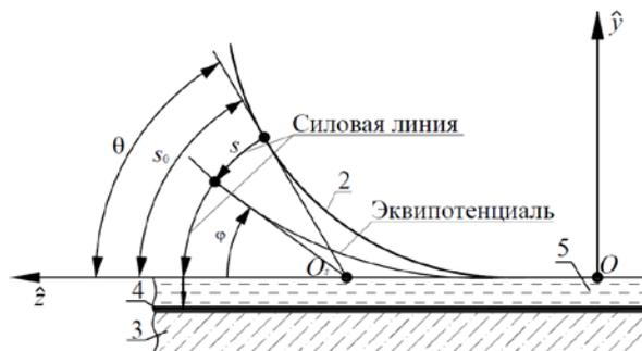
Рис. 3. Физическая модель электростатического поля
