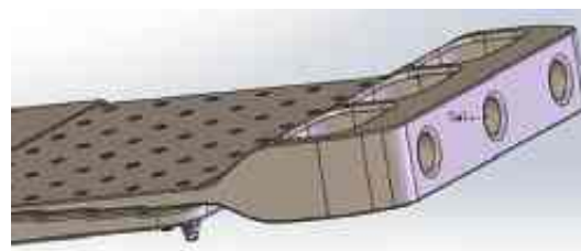
Рис. 6. Фитинговый блок титан—углепластик (три фитинговых элемента), клеболтовое соединение
