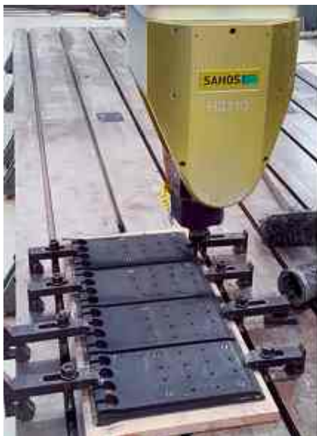
Рис. 13. Изготовление конструктивно подобного образца
