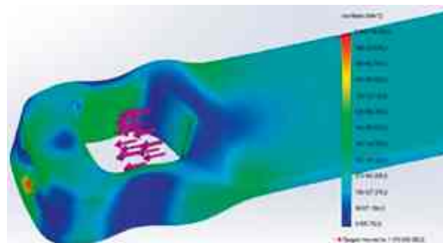
Рис. 5. Фитинговый блок из титанового сплава (a) и отдельный фитинг под той же нагрузкой на болт (b)
