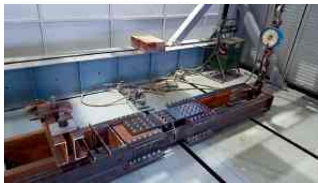
Рис. 16. Стенд для статических испытаний образца узла стыковки центроплана и ОЧК
