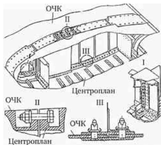
Рис. 1. Узел соединения моноблока ОЧК и центроплан
