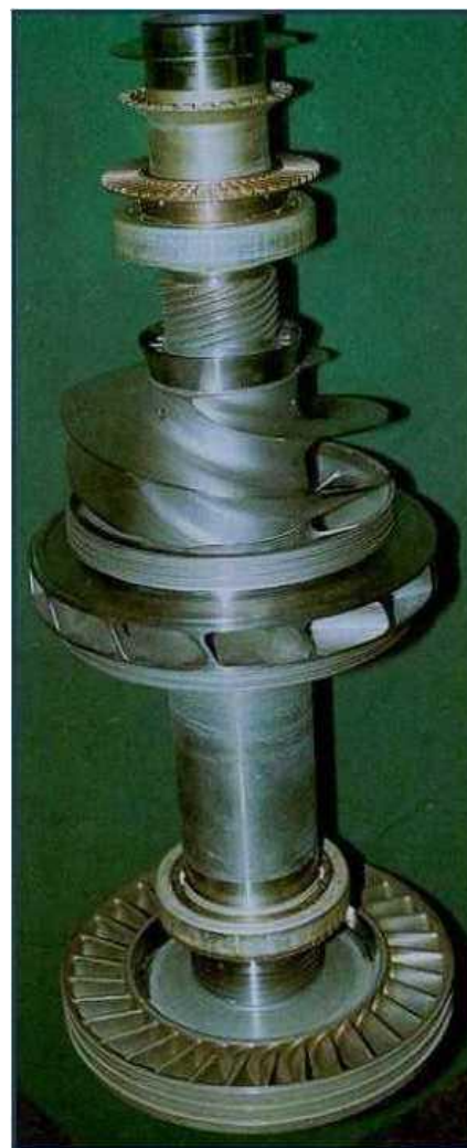
для отечественного ракетостроения ТНА ЖРД. Рисунок 1 Лопаточные системы ТНА ЖРД[7]
