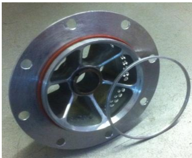
Рисунок 4 Участок трубопровода с перфорацией и направляющим аппаратом[15]
