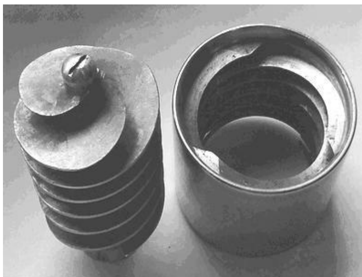
Рисунок 5 Осевихревая ступень (высокие кавитационные качества насоса).
