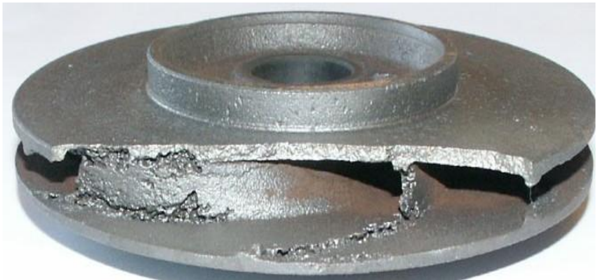
Рисунок 2 Центробежное колесо насоса, подвергнувшееся воздействию кавитационной эрозии [6]
