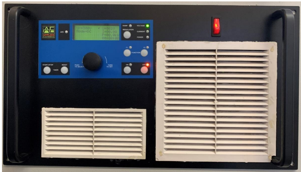
Рисунок 7. Общий вид источника питания магнетрона APEL-SB-650-12 установки УВМ-700-4М.
