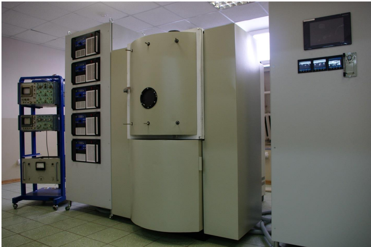
Рисунок 4. Установка магнетронного напыления с замкнутым полем УВМ-700-4М.
