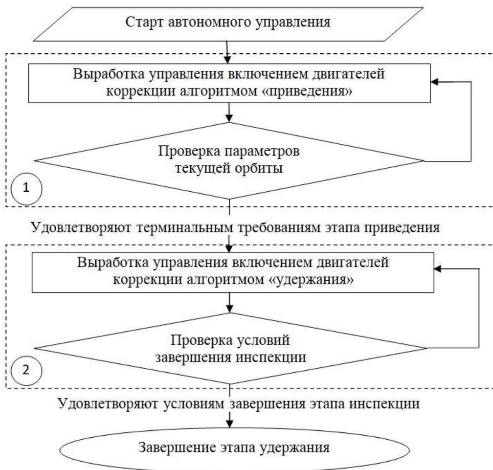
Рис. 3.1. Последовательность выполнения алгоритмов управления СМ
