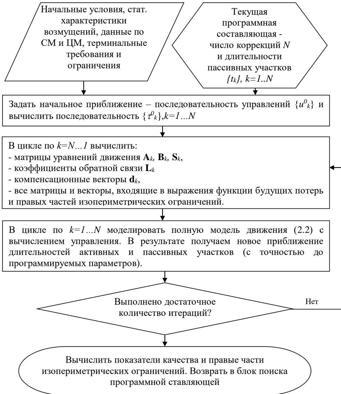
Рис. 3.6. Блок синтеза
