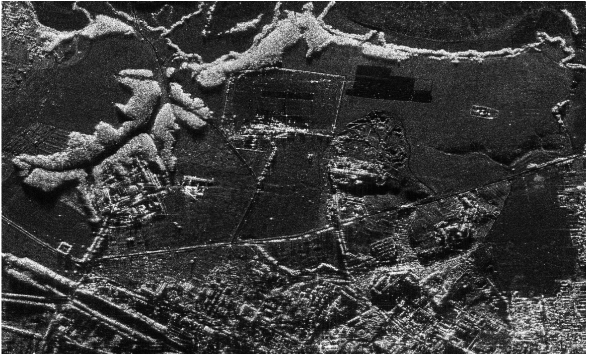
Рисунок Д.13 – РЛИ земной поверхности L-диапазона, полученное с помощью РСА «Компакт»
