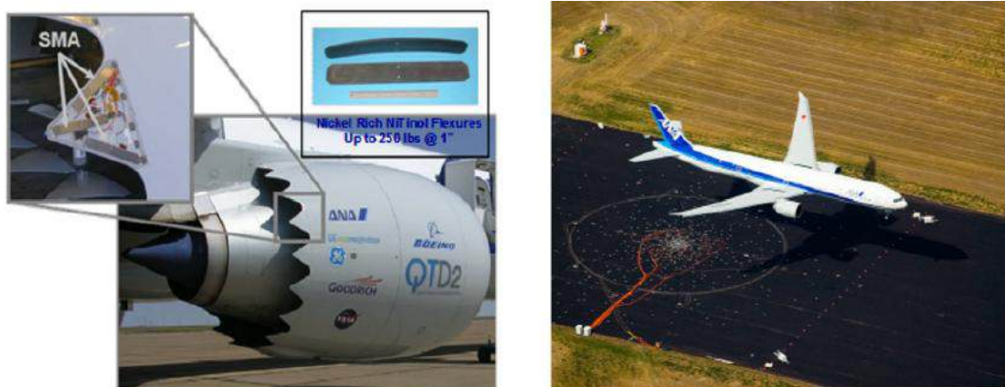
Рисунок 1.4 – Летные испытания активных шевронов, установленных на двигателях самолета Boeing 777 [11]
