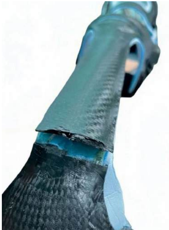
Рисунок 5.3 – Разрушение неармированного силового элемента в ортезе во время эксплуатации
