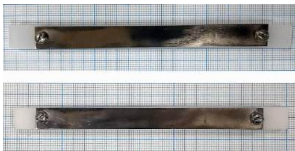
Рисунок 2.4 – Внешний вид металл-полимерных пружинных элементов, состоящих из пластины сплава Ti – 55,8 вес. % Ni и пластины ПВД ( сверху ) или ПНД ( снизу )
