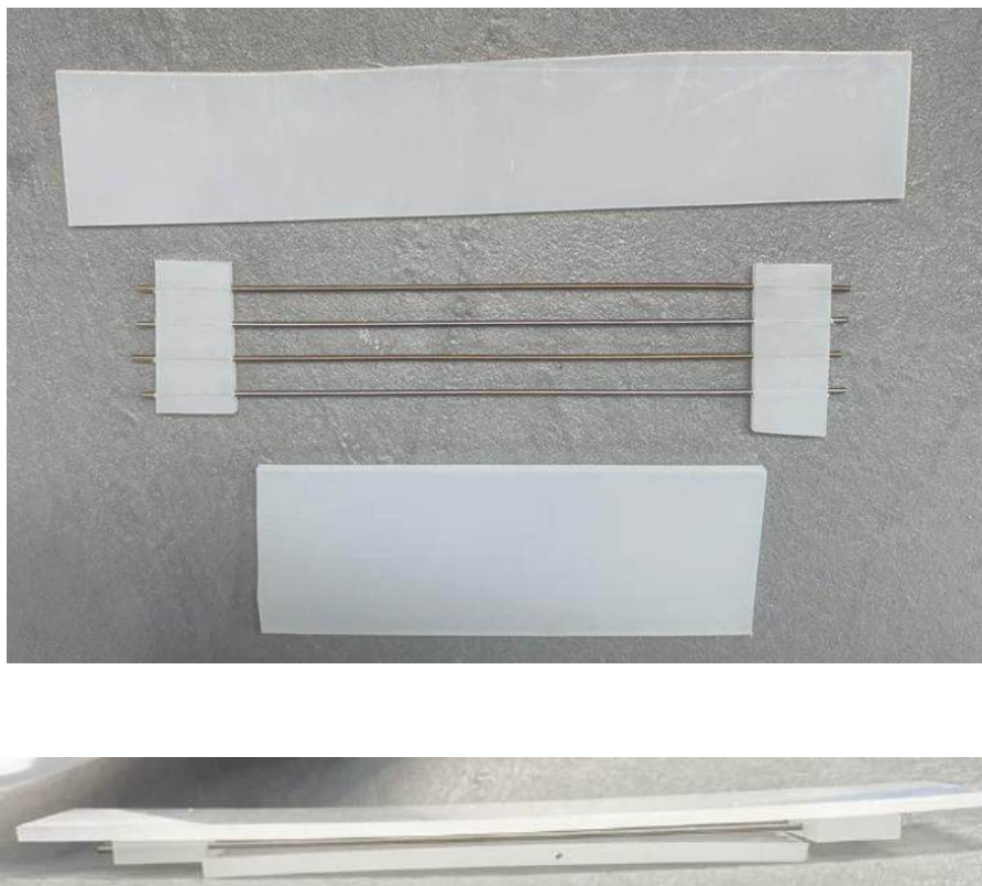
Рисунок 4.4. Подготовка полуфабрикатов к загрузке в оснастку
