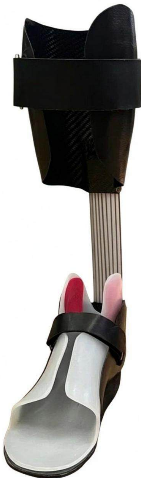
Рисунок 5.4 – Конструкция ортеза типа DAFO с ДП из КМ «ПВД – TiNi» с объемной долей сверхупругих армирующих элементов 22% (изготовлен Бурдиным Д.В.)
