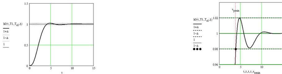
Рисунок 2.18 – График относительной переходной функции с параметрами, оптимизированными в соответствии с критерием минимума
