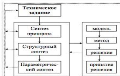
Рисунок 1.3 – Схема синтеза и анализа проектного решения при использовании макромоделей подсистемы
