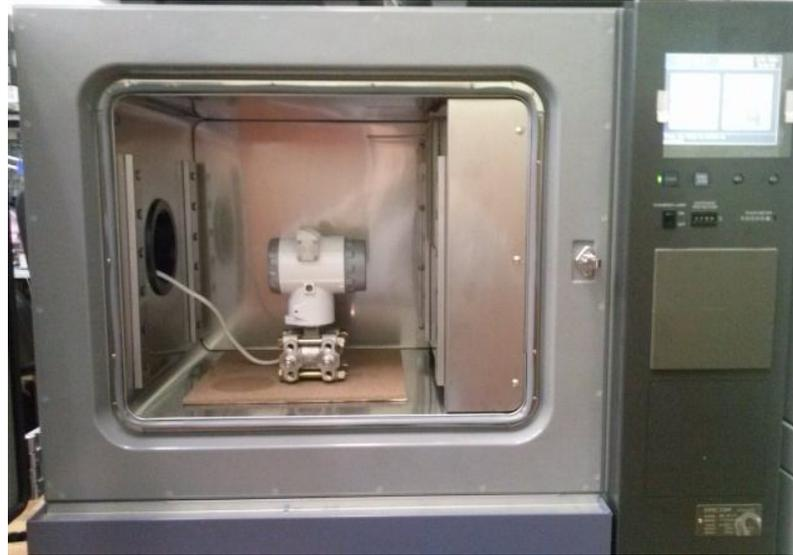
Рисунок 4.15 – Датчик давления с дифференциально-емкостным первичным преобразователем, установленный в температурной камере
