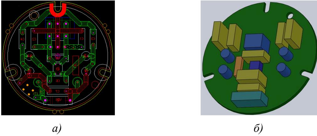
Рисунок 3.31 – Печатная плата модуля электромагнитной совместимости (а), модель модуля электромагнитной совместимости (б)
