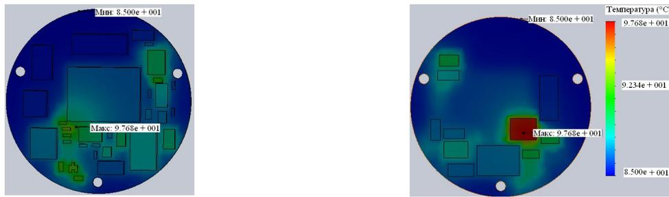
Рисунок 3.44 – Результаты проведенного теплового анализа модуля обработки информации
