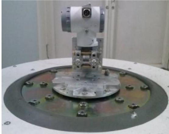
Рисунок 4.6 – Датчик давления с дифференциально-емкостным первичным преобразователем, закрепленный на вибрационной установке
