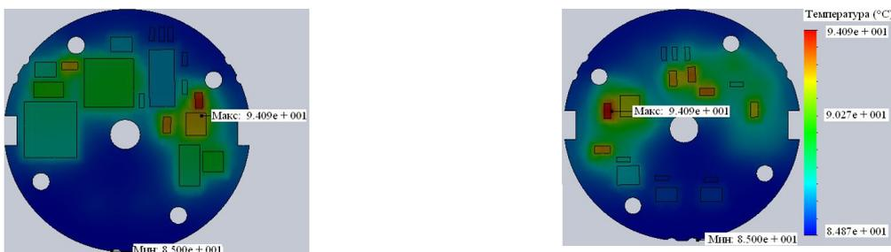
Рисунок 3.45 – Результаты проведенного теплового анализа модуля обработки информации
