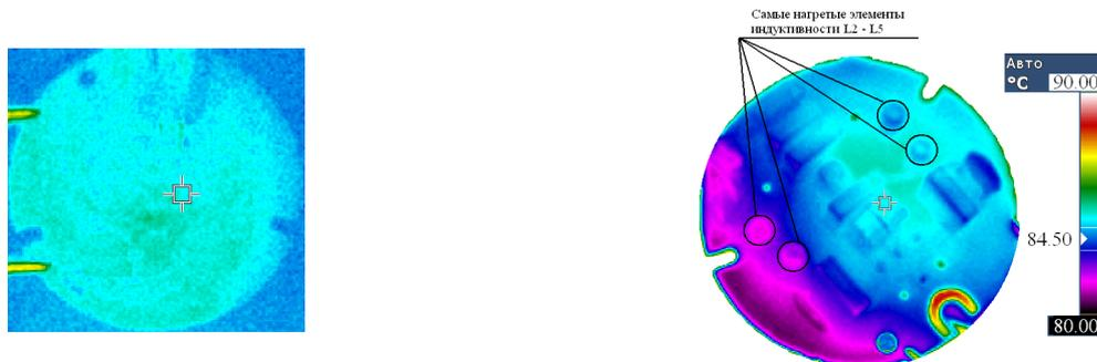
Рисунок 4.14 – Термограмма макета модуля электромагнитной совместимости
