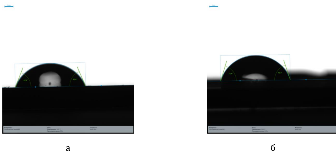
Рисунок 5 - Краевой угол смачивания поверхности образца (а) до и (б) после плазменно-жидкостной обработки.
