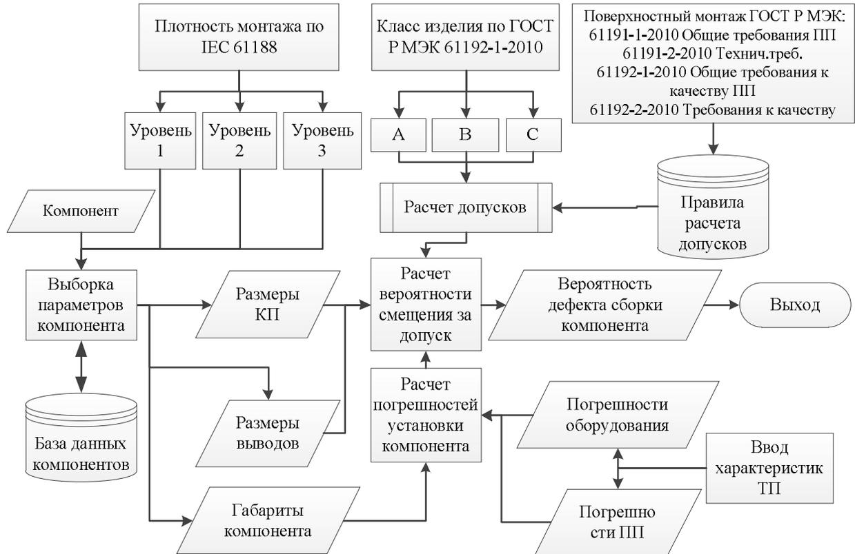
Рисунок 4.16 - Структура программного комплекса прогнозирования дефектов сборки
