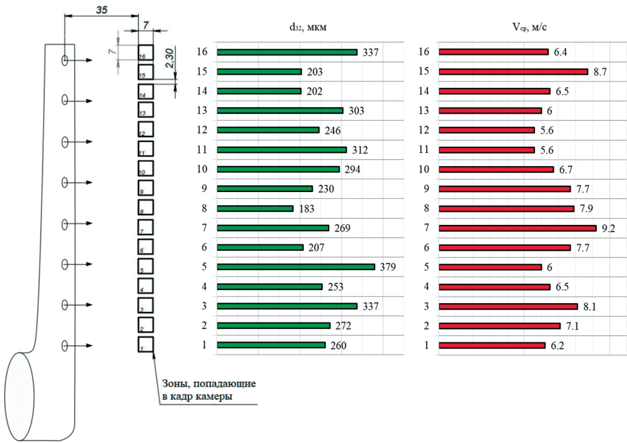
Рис. 8. Схема и результаты измерения характеристик факела распыла
