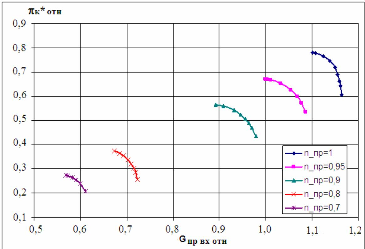
Рисунок 1 - Пример характеристики компрессора  $\pi_{\text{к отн}}^*=f(G_{\text{пр вх отн}}, n_{\text{пр}})$
