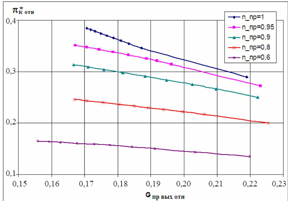
Рисунок 4 - Пример характеристики компрессора  $\pi_{\text{к отн}}^*=f(G_{\text{пр вых отн}}, n_{\text{пр}})$  в предлагаемом виде
