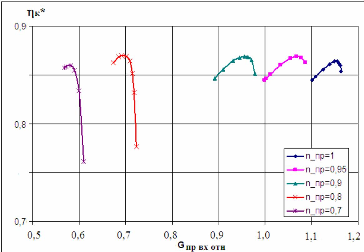
Рисунок 2 - Пример характеристики компрессора  $\eta_{\text{к}}^*=\varphi(G_{\text{пр вх отн}}, n_{\text{пр}})$ .
