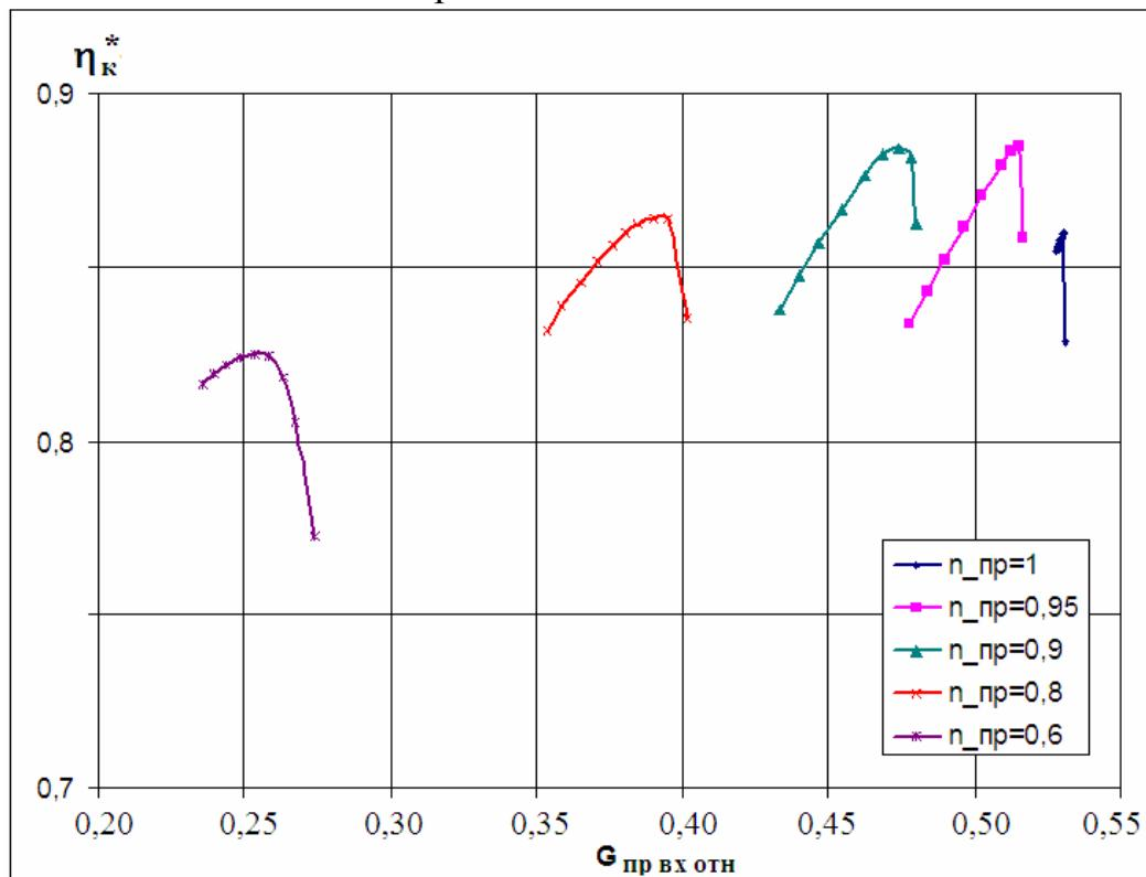
Рисунок 7 - Пример характеристики компрессора  $\eta_k^* = \varphi(G_{\text{пр\_вх}}, n_{\text{пр}})$  в классическом представлении
