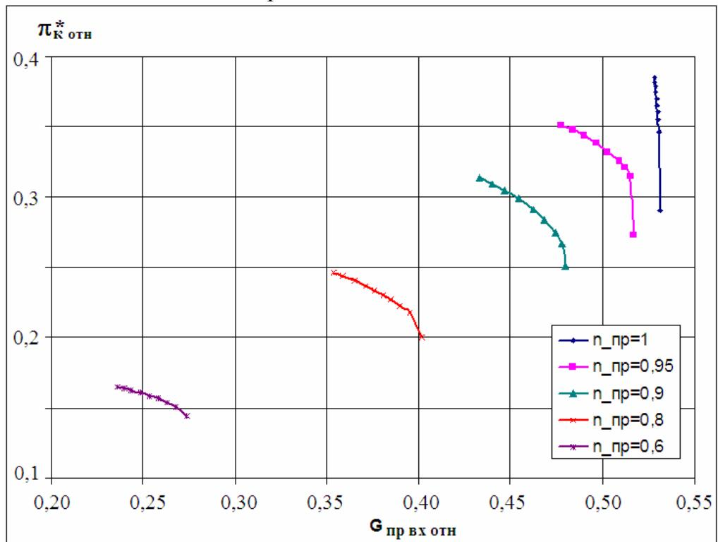
Рисунок 5 - Пример характеристики компрессора  $\pi_{\text{к отн}}^*=f(G_{\text{пр вх отн}}, n_{\text{пр}})$  в классическом представлении
