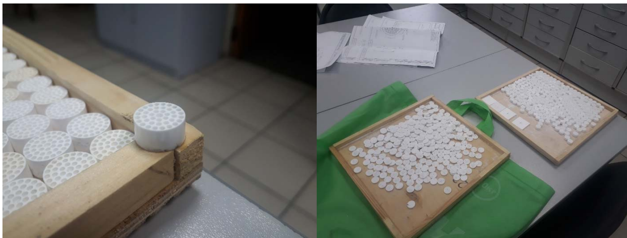
Рисунок 17 – Керамический изолятор изготовленный ГШЛ из синтезированного порошка АК12.
