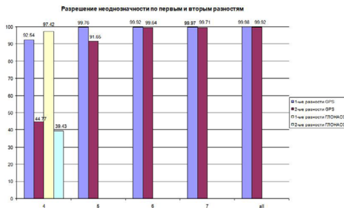
Рис. 14. Сравнение разрешения неоднозначности при использовании первых и вторых разностей псевдофаз
