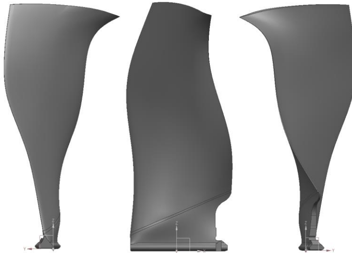
Рисунок 3.8 – Общий вид параметрической 3D-модели рабочей лопатки вентилятора «холодной» формы
