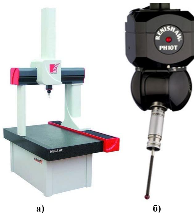
Рисунок 2.2 – Общий вид средств измерений (а – КИМ портального типа COORD3 HERA NT; б – измерительная головка Renishaw PH10M)
