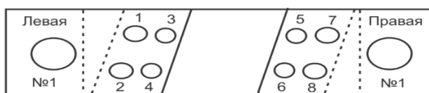
Рисунок 3 – Повреждения на обработанных сверлом краях отверстий (характерная глубина повреждений 0.1мм)
