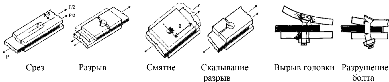
Рисунок 25 – Формы разрушения композитных соединений
