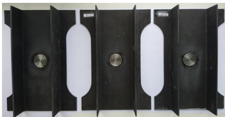
Рисунок 32 – Образцы с произведенным ремонтом, вид со стороны стрингеров
