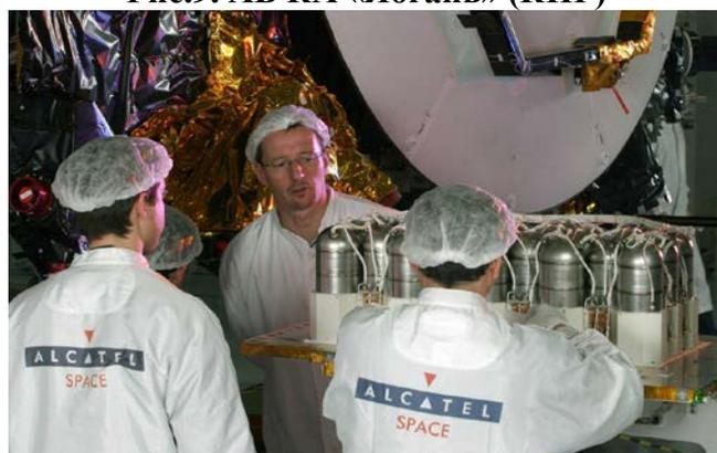
Рис.10. НВАБ платформы Spacebus-4000, TAS (Франция)
