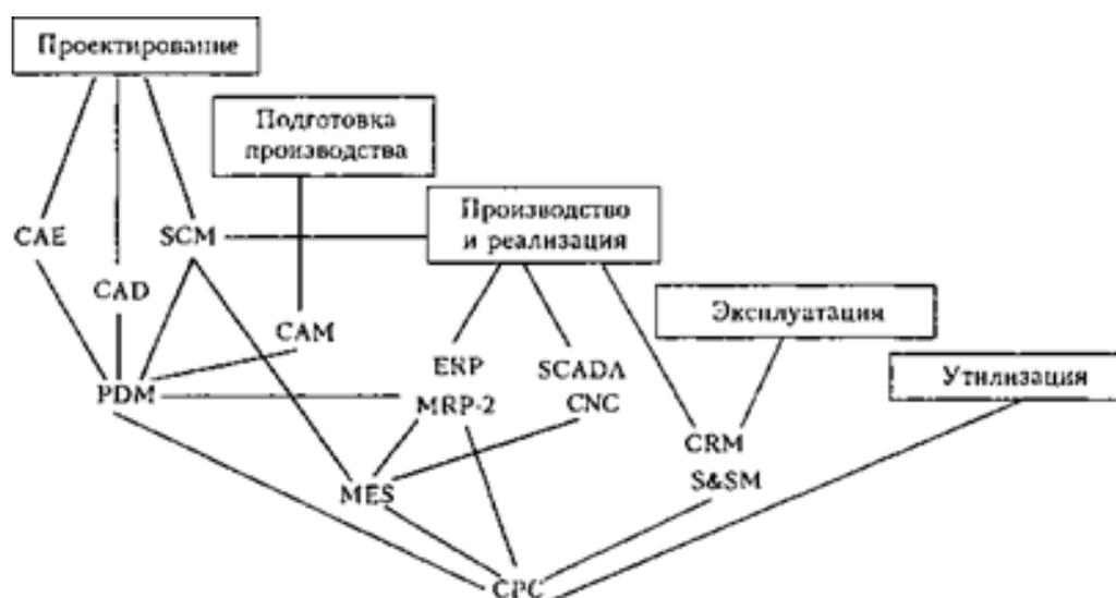
Рисунок 9. Этапы жизненного цикла промышленных изделий и системы их автоматизации
