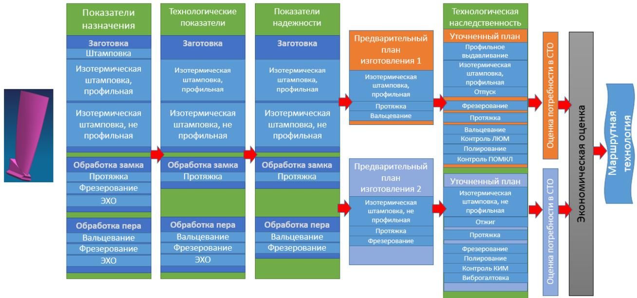
Рисунок 17. Пример применения методики выбора технически обоснованной технологии изготовления лопатки.
