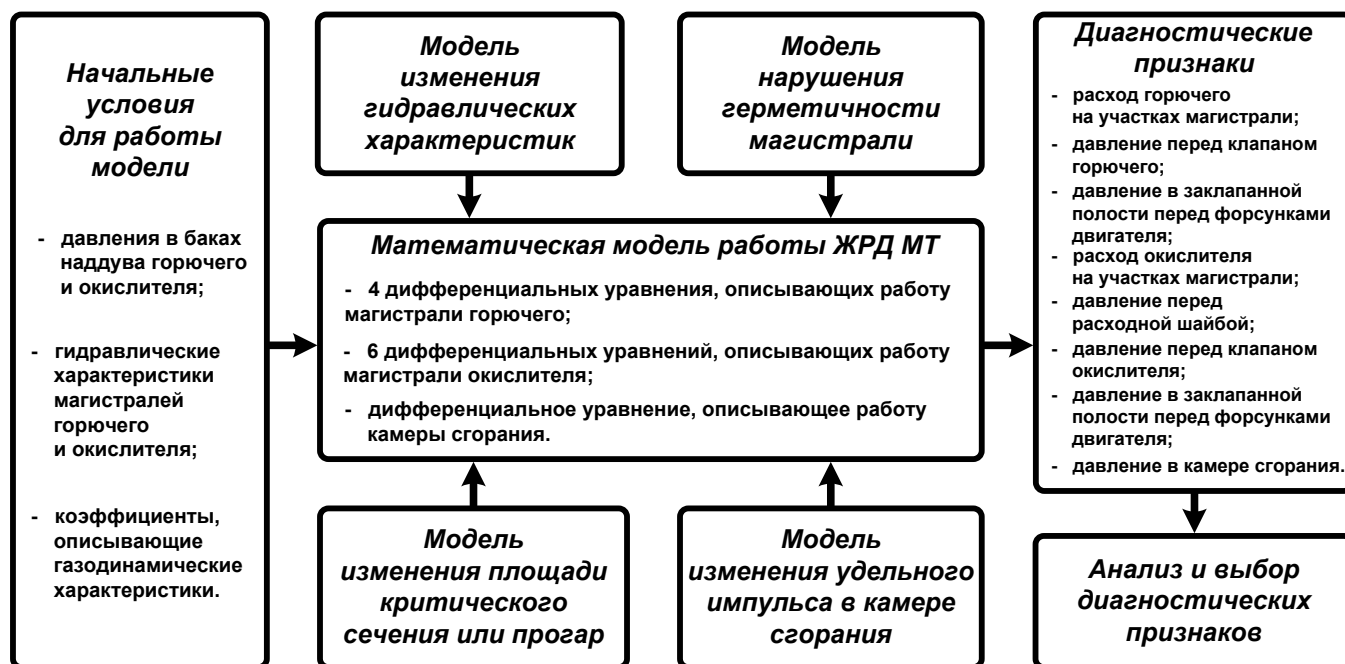
Рис. 2. Комплексная диагностическая модель работы ЖРД МТ
