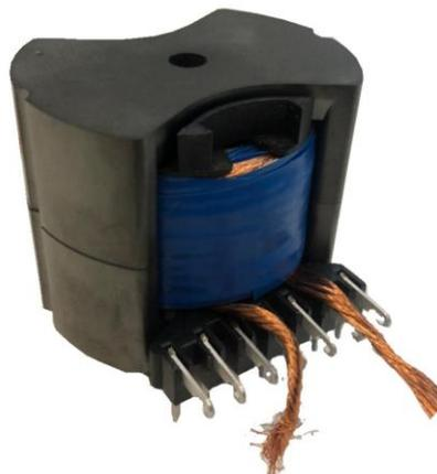
Рисунок 5.4 – Внешний вид дроссель - трансформатора.
