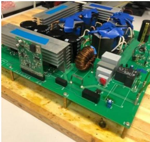
Рисунок 5.6 – Внешний вид макета однофазного зарядного устройства с функцией корректора коэффициента мощности (вид2).
