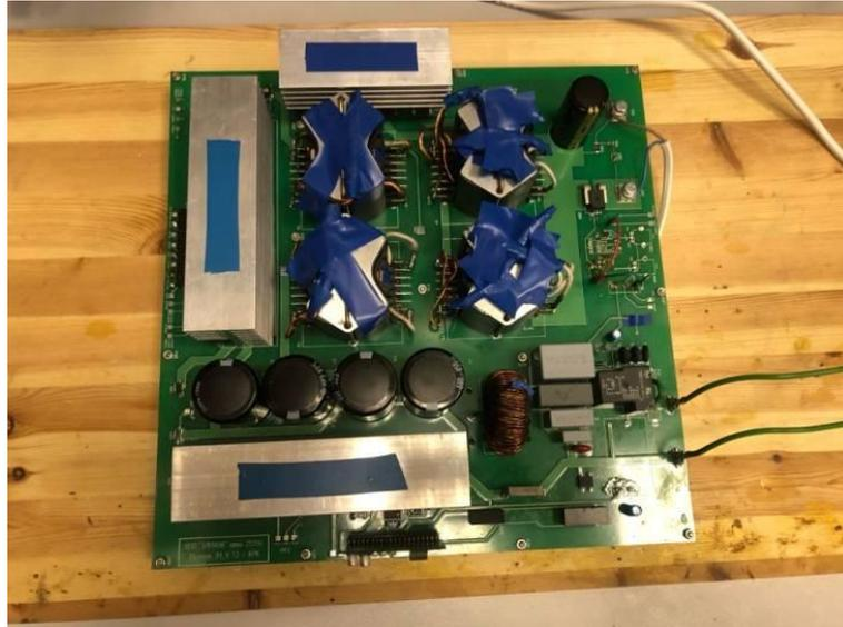
Рисунок 5.6 – Внешний вид макета однофазного зарядного устройства с функцией корректора коэффициента мощности (вид1).
