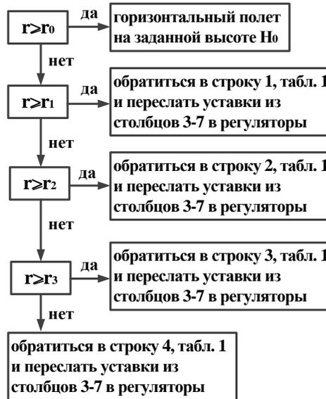
Рисунок 2 – Блок-схема алгоритма автоматического переключения режимов управления посадочным маневром
