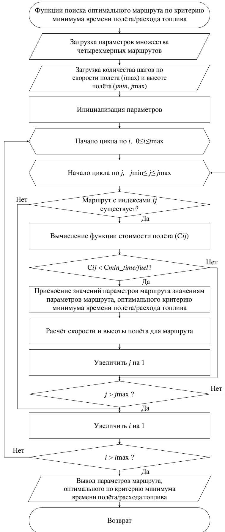
Рисунок 33 – Блок-схема алгоритма поиска оптимального маршрута по критерию минимума расхода топлива/времени полёта
