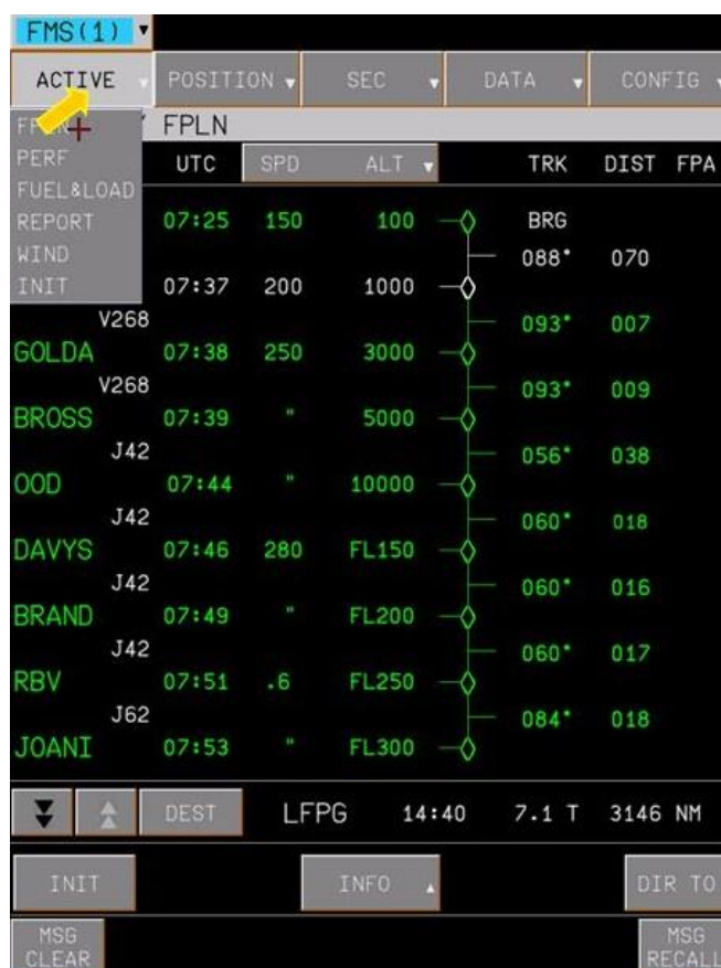
Рисунок 3 – Общий вид кадра ЧМИ FMS самолёта A380 с применением ARINC 661
