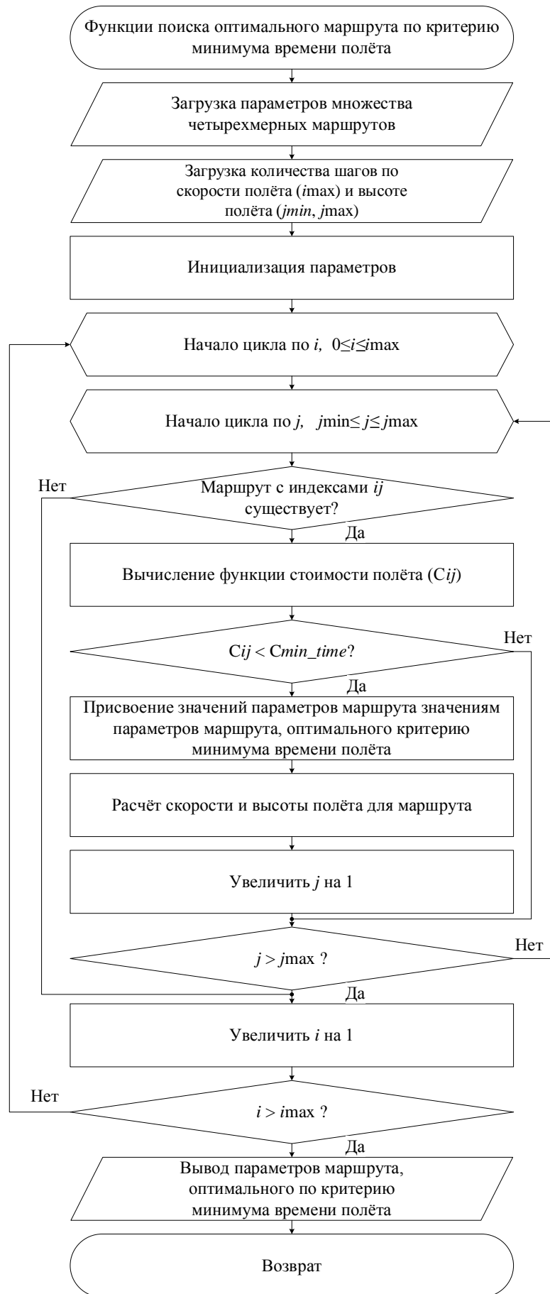
Рисунок 32 – Блок-схема алгоритма поиска оптимального маршрута по критерию минимума времени полёта
