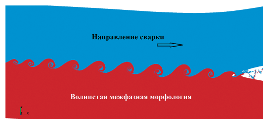
Рис. 10. Морфология волнистой поверхности и формирование гребней
