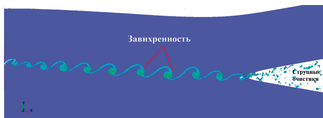
Рис. 11. Морфология волнистой поверхности и явление образования струи при косой ударной сварке титановой и медной пластин
