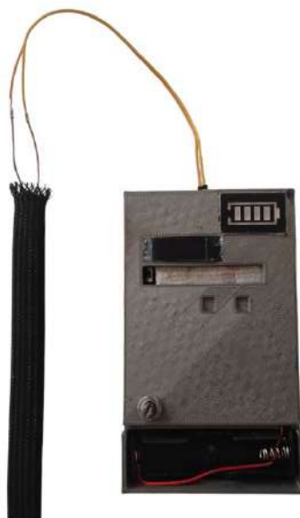
Рисунок 86 – Внешний вид устройства: а) спереди: 1 – индикатор состояния заряда; 2 – монитор 0,91 дюйм; 3 – интерфейс, который содержит тумблер для включения, кнопки меню, ОК и сброса, светодиод состояния стабильной работы и светодиод состояния утечки; 4 – потенциометр, для задавания параметров работы сенсора; 5 – батарейный отсек сенсора; б) сзади, задняя часть представляет собой сенсор, закрепленный между электродами сверху и снизу; в) Цифровой модуль с внешне выведенным сенсором утечек углеводородов
