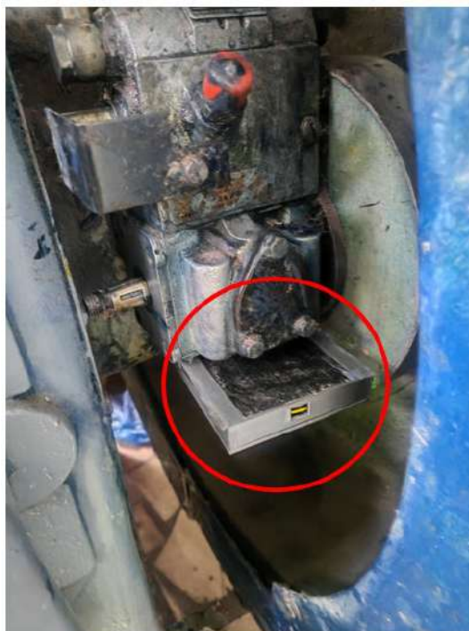
Рисунок 91 – Сенсор на гидравлической системе на вальцевой машине
