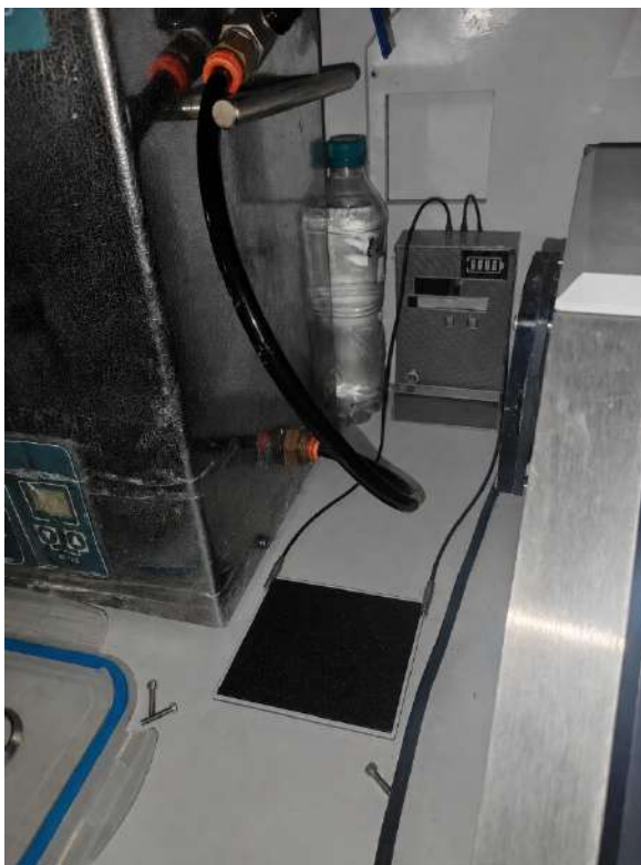
Рисунок 94 – Размещение сенсора утечек углеводородных жидкостей в зоне установки ультразвуковой ванны «Сапфир»
