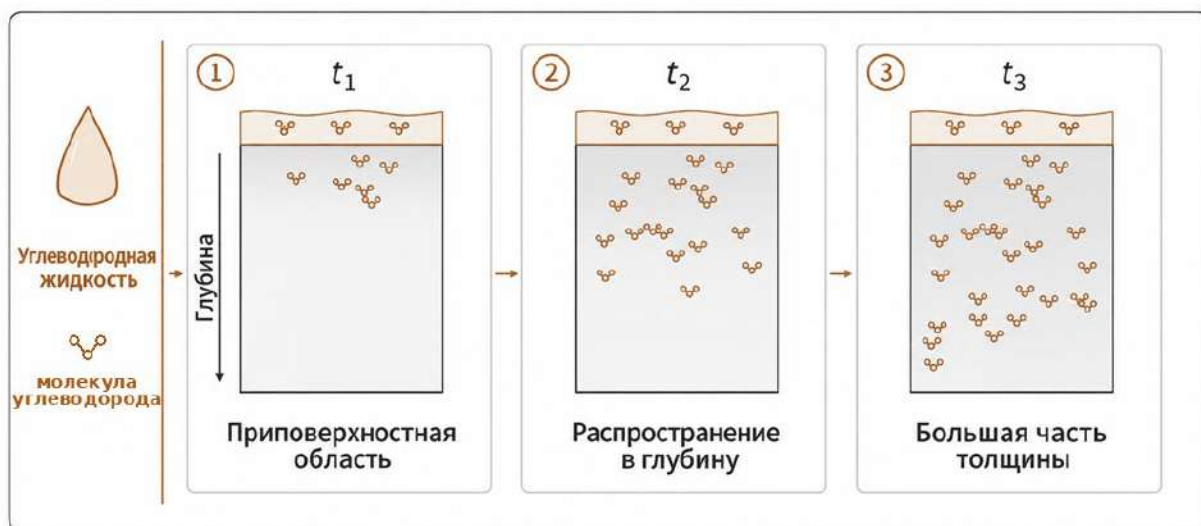
Рисунок 29 – Распределение абсорбированного углеводорода по толщине чувствительного элемента в различные моменты времени: t_1 - начало абсорбции; t_2 - промежуточный момент абсорбции; t_3 - конец абсорбции
