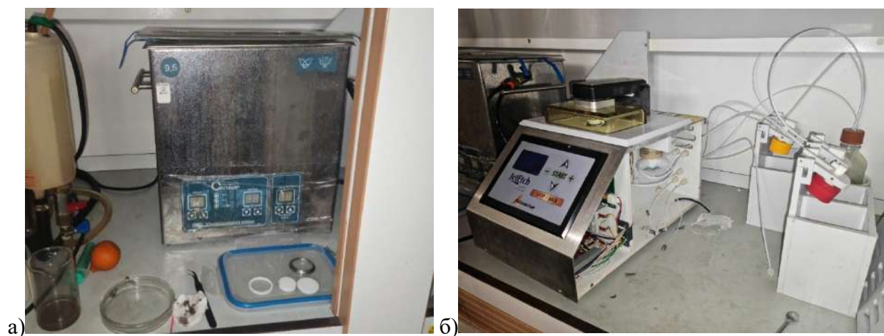
Рисунок 92 – Фото оборудования для внедрения: а) ультразвуковая ванна «Сапфир»; б) система автоматической химической декапсуляции микросхем «JetEtch Pro»
