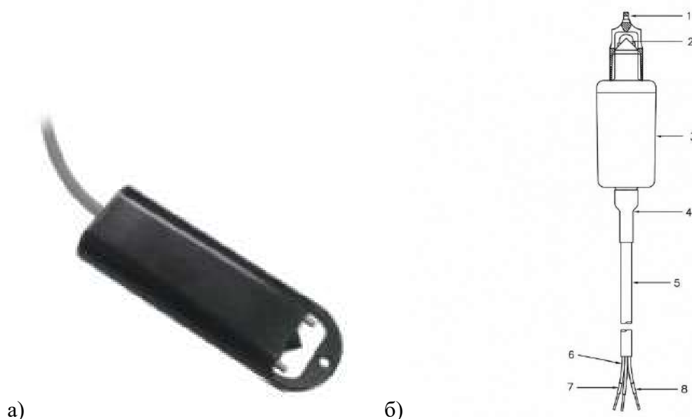
Рисунок 8 – Сенсора FMP-DIS: а) внешний вид; б) конструкция: 1 – защитный колпачок; 2 – рабочая чувствительная головка с электрооптическим элементом; 3 – корпус сенсора с электронной схемой обработки сигнала; 4 – влагостойкая термоусадочная втулка; 5 – соединительный четырехжильный кабель в оболочке; 6 – питания +5 В; 7 – сигнальный; 8 – земля
