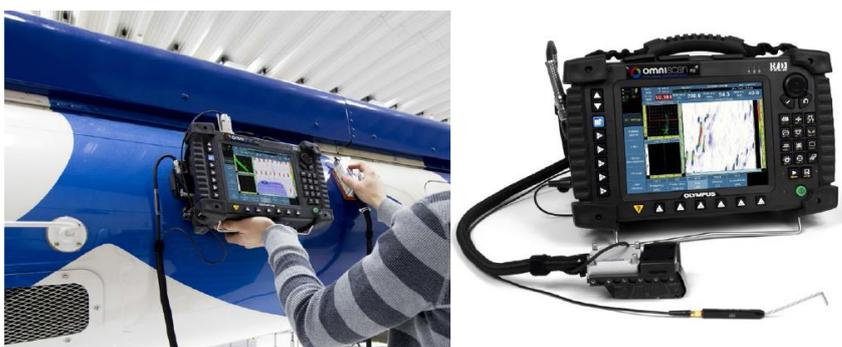
Рис. 11. Мобильный ультразвуковой дефектоскоп
