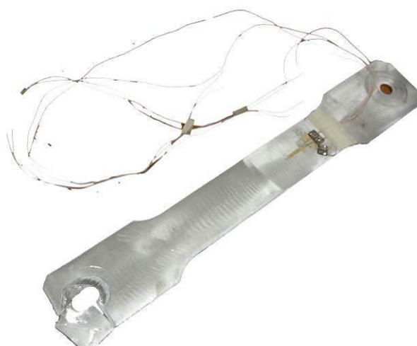
Рис.48. Образец, установленный в патрон и после нагружения
