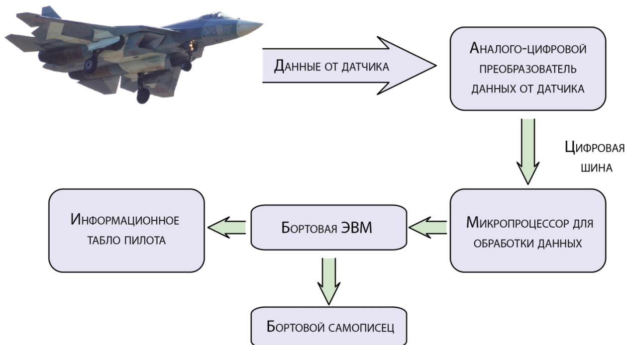
Рис. 14. Принцип работы системы непрерывного мониторинга состояния конструкции [111]
