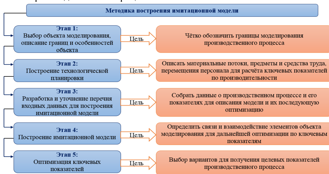
Рисунок 9 – Методика построения имитационной модели производственного процесса
