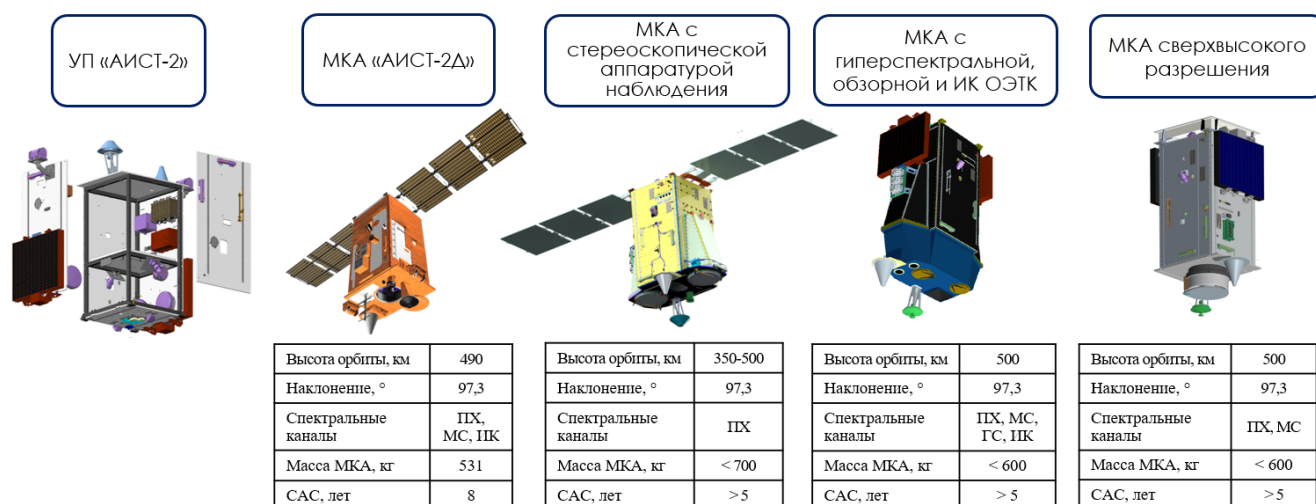
Рисунок 4 – Проектный облик МКА ДЗЗ на базе УП «АИСТ-2»
