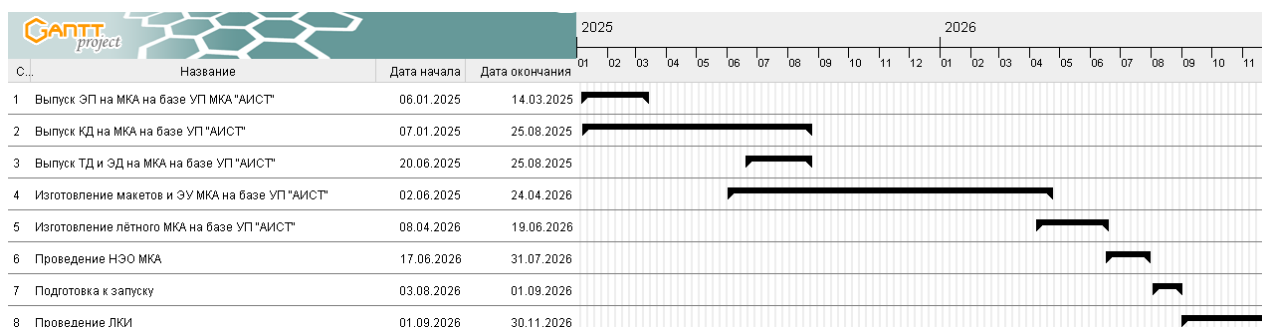
Рисунок 25 – Диаграмма Ганта создания нового МКА на базе УП «АИСТ-2»
