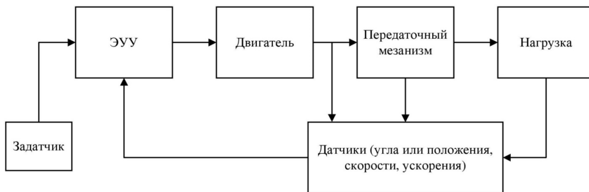
Рисунок 1 –Обобщенная структурная схема электропривода
