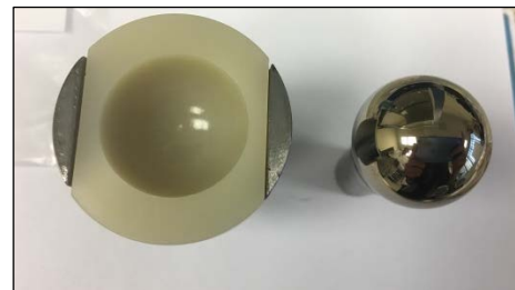
Рисунок 5.3 – Внешний вид головки и имитатора чаши в испытательной оснастке до (а) и после (б) проведения триботехнических испытаний
