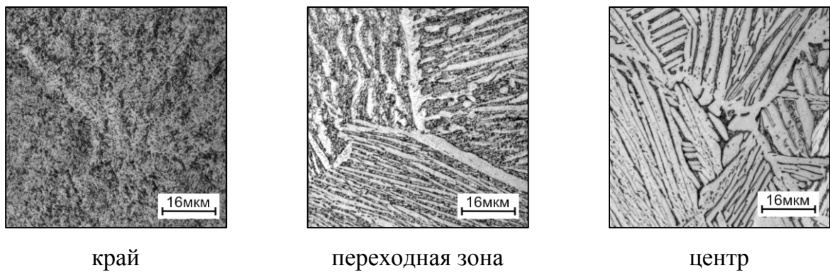
Рисунок 1.20 – Градиентная структура образца из сплава ВТ6 [99]
